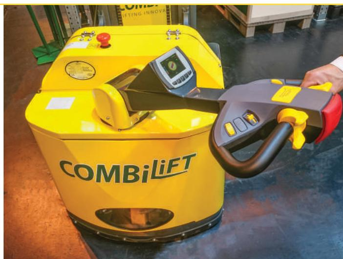
Incorporando de los beneficios de la tecnología AC en sus motores de tracción, bomba y dirección, la Combi-CS tiene una altura de elevación que se puede adaptar a su aplicación con capacidades de carga de hasta 1.000kg.
